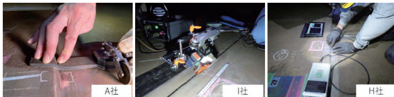
写真4 5,000キロリットルタンクによる現地試験での探傷状況。 各社のプローブは、種類(形状)によるアレイ方式(フレキシブルテープ型)/シングル方式(ペン型)と、方式による差動方式/相互誘導方式の組合せとしている。部位に合わせたプローブ選択が求められる。
