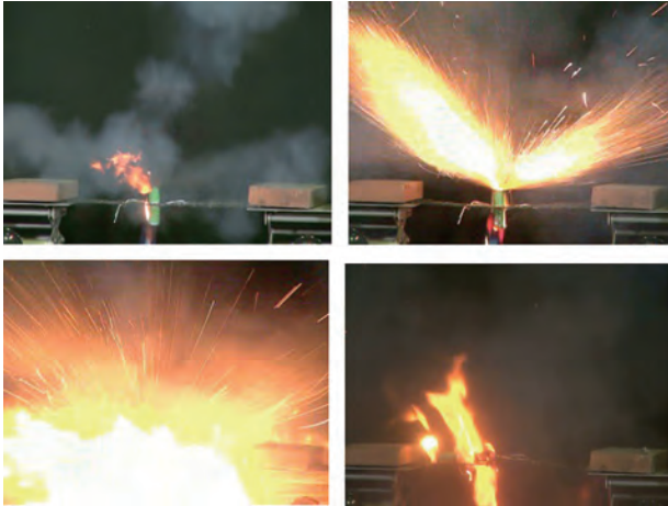
写真6 燃烧した電池
