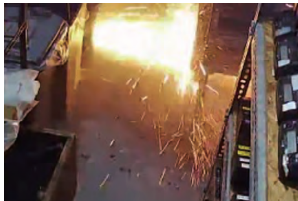
写真7 電池の出火から火災に至った事例（東京消防庁のホームページ 41 ） （左：出火直後、右：激しく燃焼している状態）
