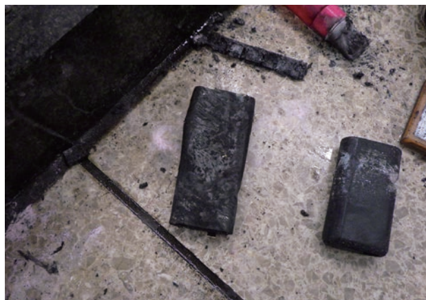
モバイルバッテリーの焼損状況
