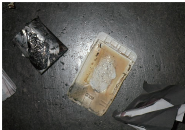
モバイルバッテリーの焼損状況
